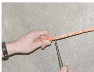
(2) Insert punch in ScraperRope™
